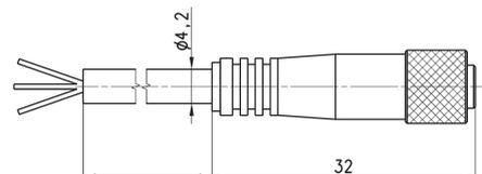
В случае, использования 2-х проводного датчика с разъемом M8 (CST-250N, CSV-250N и CSH-253), соедините коричневый провод с "+" источника питания, а черный с нагрузкой.
